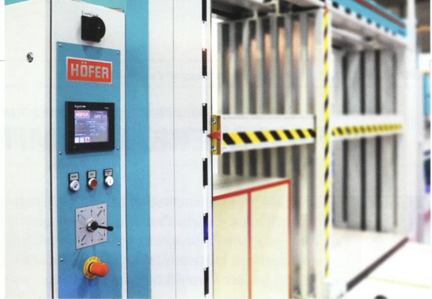
Komfortable Touchscreen-Bedienung auch an der Korpuspresse, verstärkte Druckbalken bürden für eine möglichst geringe Durchbiegung und damit eine exakte Winkelhaltigkeit.
