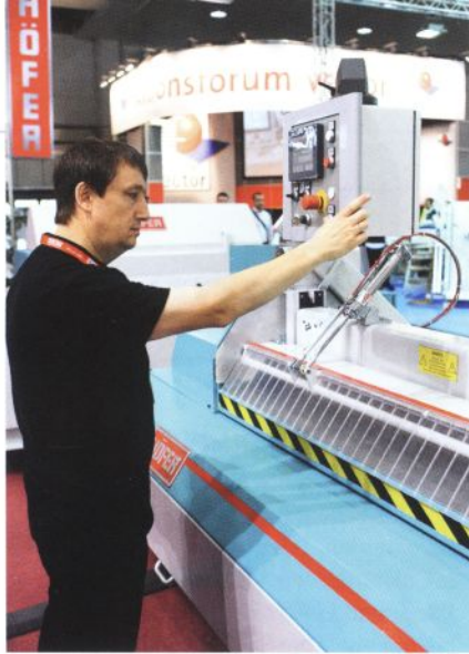
Die Schnittlänge wird automatisch bestimmt, der Kopf kann sofort umsteuern.
